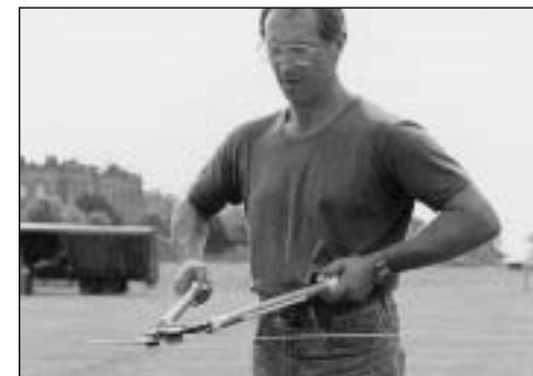
Opstramning af Gripple værktøj (16611).
